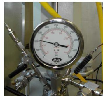
Объем реактора – 600 мл. Укомплектован термопарой, манометром, перемешивающим устройством, электрическим нагревателем, охлаждающим змеевиком.
