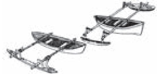
**АХИМА**, африканское каноэ, выдолбленное из ствола дерева, используемое для рыбной ловли. На крупных А. на носу на 60 см наращены борта для предохранения от попадания воды. Африканцы выходят на А. в море, пользуясь прямоугольным плетёным парусом, закреплённым на мачте. Имеет бамбуковый бушприт. Парусом управляют с помощью шкотов. Иногда на 2 или 3 шестах поднимают дополнительный прямоугольный парус. Длина 3–9, ширина 0,6–0,9 м.
